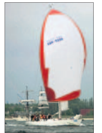
Die „Boatmen“ wurde 1989 als Whitbread-Racer in Frankreich gebaut. Die 17,45 Meter lange und fünf Meter breite Aluminium-Rennyacht hat einen Tiefgang von 3,10 Metern. Der Mast ist 24,10 Meter hoch, die Segelfläche am Wind beträgt 175 Quadratmeter. FOTO: BOATMEN
